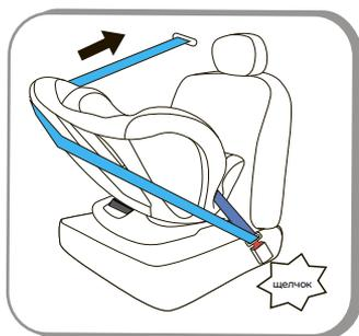
**Шаг 4:** Вставьте диагональный ремень вместе с поясным ремнем в пряжку ремня безопасности автомобиля, услышите “щелчок”. Проверьте правильность фиксации пряжки ремня безопасности автомобиля, потянув ремень безопасности вверх.
