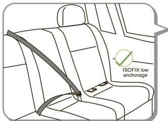
Это детское сиденье подходит для использования во всех автомобилях, оснащенных 3-точечными ремнями безопасности, установленными в соответствии с Правилами №16 ЕЭК ООН или другим эквивалентным стандартом. Детское сиденье должно быть установлено с помощью поясного и диагонального ремня безопасности.
