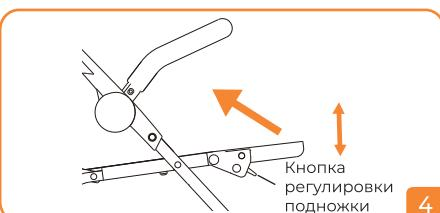
**4.** Регулировка подножки: нажмите на кнопки с двух сторон и отрегулируйте подножку до нужного положения.
