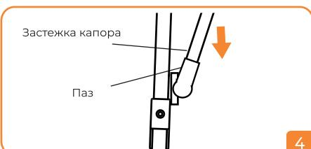
**4.** Установка капора: вставьте застежку капора в паз до упора. Проделайте тоже самое с другой стороны.
