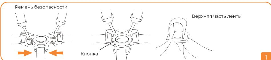
**1.** Использование ремня безопасности и поперечного ремня. Пряжка: вставьте фиксаторы в пряжку как показано стрелками на рисунке. Чтобы расстегнуть ремень, нажмите кнопку. Для регулировки длины потяните ленту ремня вверх и настройте комфортную длину для вашего ребенка.
