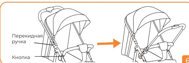
**6.** Перекидная ручка: нажмите кнопки с двух сторон, перекиньте ручку в реверсивное положение до щелчка. Ручка зафиксирована.
