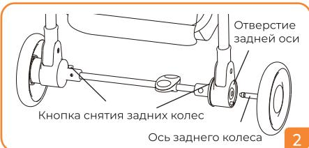
**2.** Установка задних колес: вставьте задние колеса в боковые отверстия задней оси до щелчка. Для снятия колес нажмите кнопку и потяните колесо.
