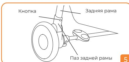
**5.** Установка и снятие задней рамы: зажмите кнопки с двух сторон для установки и снятия рамы.
