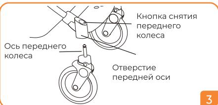
**3.** Установка передних колес: вставьте передние колеса в отверстие передней оси до щелчка. Для снятия нажмите кнопку и потяните колесо.
