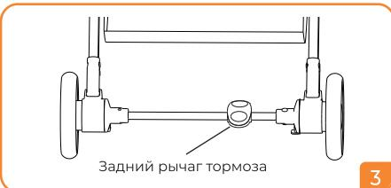
**3.** Использование заднего тормоза: нажмите задний тормоз чтобы зафиксировать коляску
